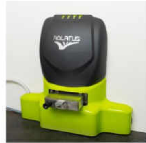
S700 Servicestation für autonomen 24/7 Betrieb Vollautomatische Wasser- und Batterieaufladung
