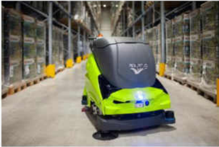
CR700C Zylindrische Bürsten Nimmt auch groben Schmutz auf und reinigt effizient in einem Arbeitsgang
