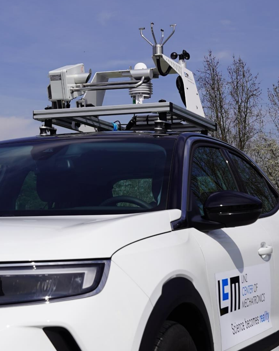
Hochwertige Wettersensorik, montiert am Autodach (Bild oben) und im Einsatz auf der DigiTrans Teststrecke (Bild rechts)
