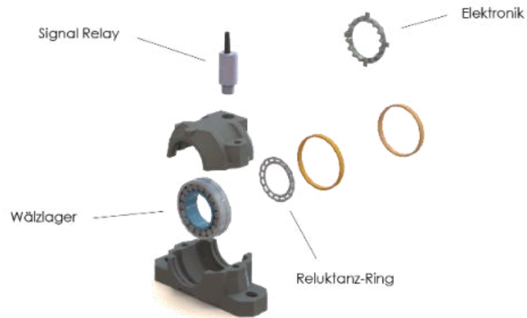
Hauptbestandteile Modulares Sensorsystem (MoSS)
